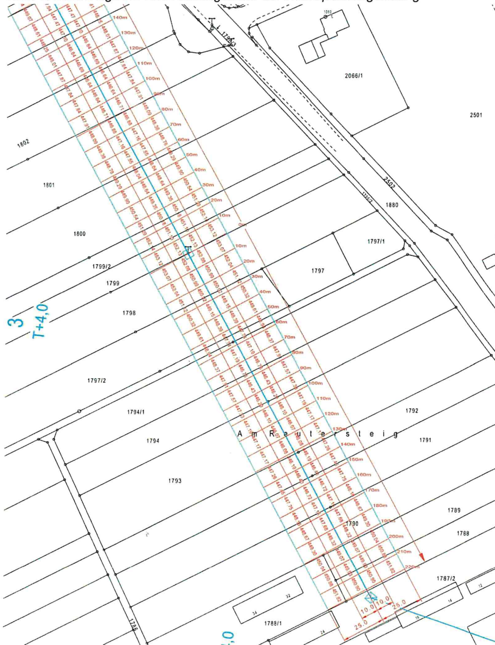
Abb. 1: Max. mögliche Unterbauungshöhe der Hochspannungsleitung
