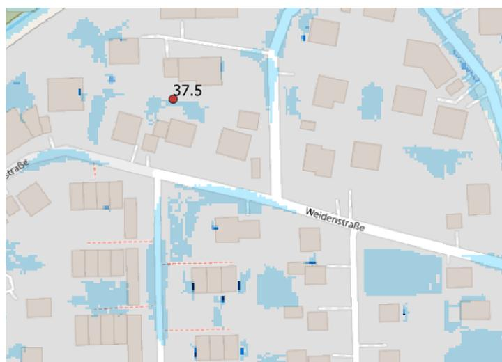
Abbildung 66: Feuerwehreinsatz (roter Punkt) mit Untersetzung täglicher Niederschlagsmenge (d/mm) und berechnete Wassertiefen (belastungsabhängige Berechnung, orientierende Untersuchung) bei  $T = 100$  a,  $D = 90$  min. Quelle: Eigene Darstellung.
