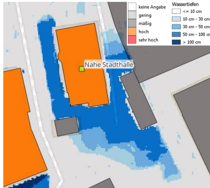
Abbildung 70: Gefahrenpunkt Nahe Stadthalle,  $T = 100$  a,  $D = 60$  min. Quelle: Eigene Darstellung.
