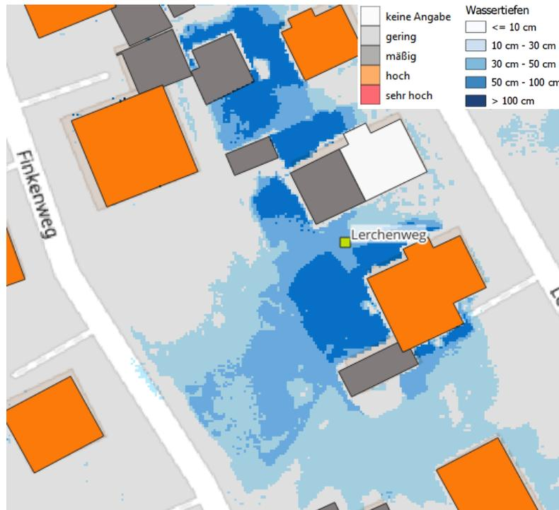
Abbildung 71: Gefahrenpunkt Lerchenweg,  $T = 100$  a,  $D = 60$  min. Quelle: Eigene Darstellung.
