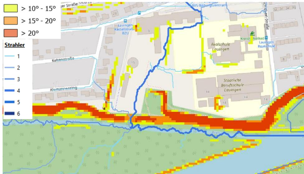
Abbildung 29: Steilstufe im Auwald mit Hangneigung in Grad und Ergebnisse der Fließweganalyse (Darstellung – Methode Strahler). Quelle: Eigene Darstellung.
