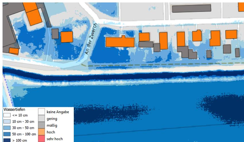
Abbildung 91: Gefahrenpunkt An der Zwerch, Zwergbach/Zwerggraben,  $D = 100$  a,  $D = 540$  min. Quelle: Eigene Darstellung.
