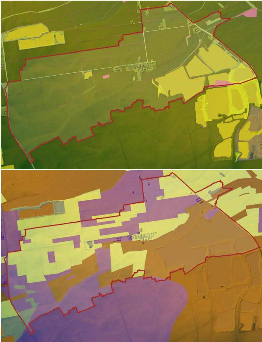
Abbildung 43: Einzugsgebiet Schackenlachgraben mit Unterteilung der Landnutzung (oben) und HSG-Bodenklassen (unten). Quelle: Eigene Darstellung.
