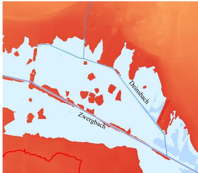
Abbildung 57: Wassertiefen des  $HQ_{\text{häufig}}$  am Zwergbach im Mündungsbereich des Deinsbachs. Quelle: Eigene Darstellung.
